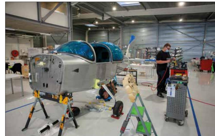
**Quand les sous-ensembles arrivent dans l'usine, le plus important est la cellule en partie assemblée. Elle recevra assez vite le câblage mécanique et électrique. Le train est déjà monté. Le moteur sera accouplé pour équilibrer la cellule.**
